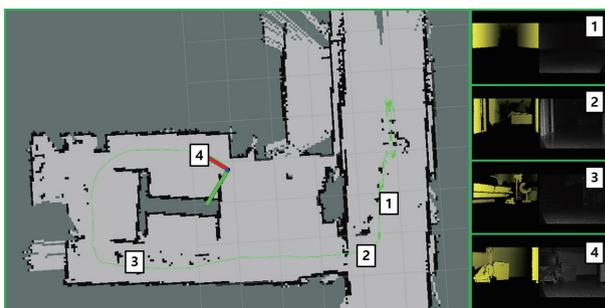
Fig 3. LiDAR 및 3D-Depth Camera를 이용한 실내 환경 맵핑
